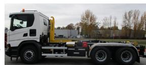
→ Bras **S21** monté sur châssis 6x4 NTG Nouvelle génération .....
