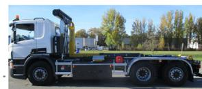
→ Bras **T20** monté sur châssis 6x4 Nouvelle cabine .....
