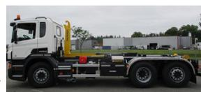
→ Bras **T20** avec PALCOVER monté sur châssis 6x2 GNC (au gaz) .....
