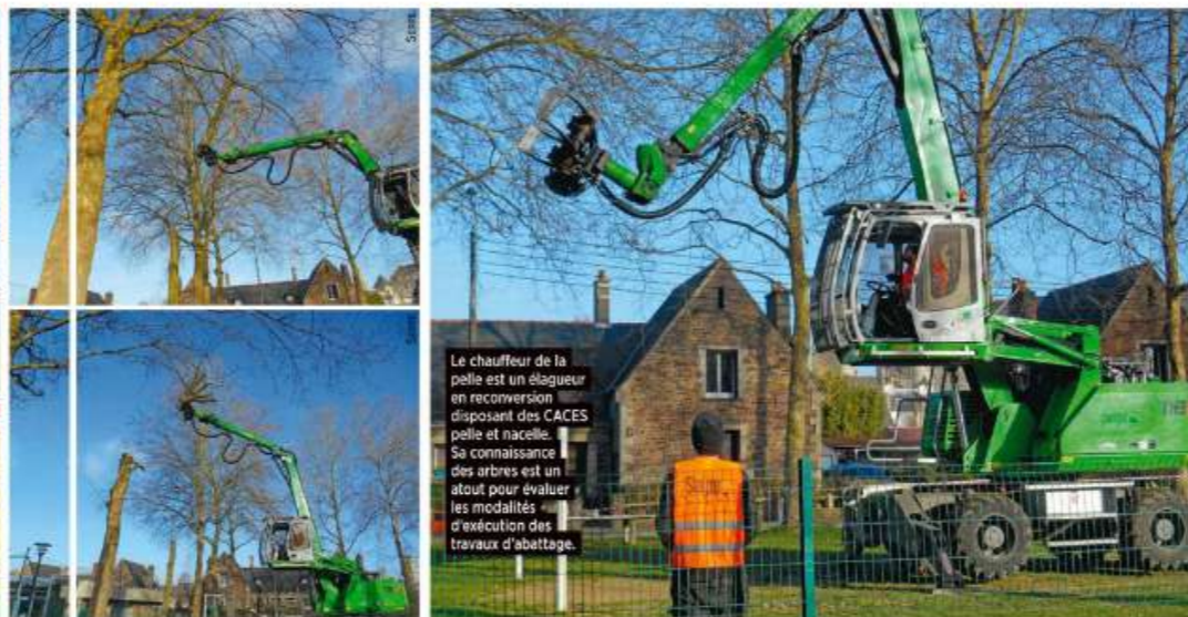
La découpe des charpentières (en haut) et du houppier dans son entier (ci-dessus) est un préalable nécessaire à l'utilisation de la pelle. Cela, afin d'éviter une charge trop importante pour le grappin.
